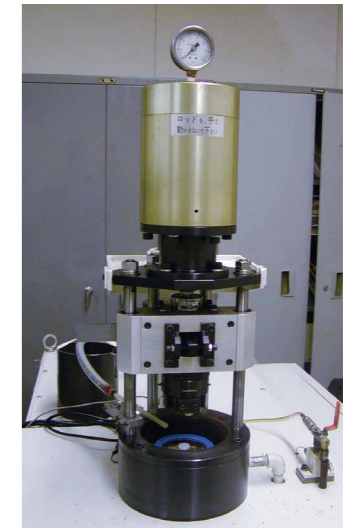
照片 B-11 : 销盘式摩擦磨损试验机 Photo B-11 : Pin-on Disk test machine
