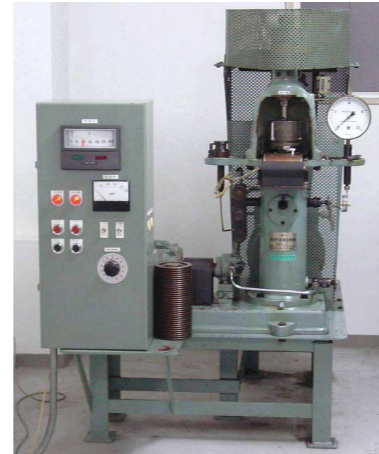
照片 B-14 : 曾田式四球磨损试验机 Photo B-14 : SOTA-4-Ball wear test machine
