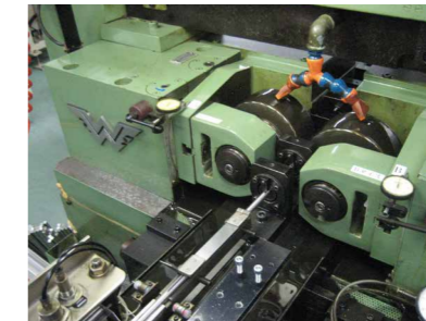
롤링 다이스에 의한 전조가공 Rolling process by Rolling dies
